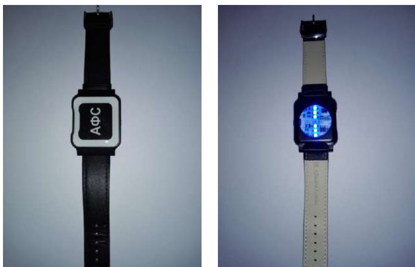
Рис. 2. Светодиодный аппарат АФС мощностью 30 мВт
